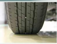
タイヤは紫外線などの影響により、素材であるゴムの疲労や劣化が進行し、 ひび割れが発生することがあります。ひび割れがタイヤ内部まで進行するとパ ンクなどの原因となり、危険です。タイヤの全周をチェックし、著しいひび割れの 有無とともに小石や釘などの異物が噛みこんでいたり刺さっていたりしてない かを確認しましょう。その際、もし異物が刺さっていてもその場で引き抜いたり せず、自動車整備工場と相談の上、修理またはタイヤ交換を実施してください。
