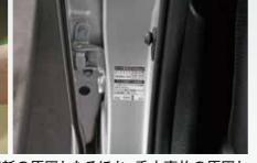
空気圧の低下は燃費の悪化や偏摩耗の原因となるほか、重大事故の原因となるバーストの危険性も高まります。運転席のドア周りに貼付されているラベルで指定空気圧を確認して空気を充填しましょう。
