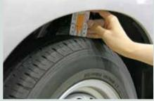
法令により、タイヤの溝の深さは1.6mm以上なければなりません。摩耗が進み、残り溝が1.6mmになるとスリップサインが出てきて溝が途切れます。溝が浅くなったタイヤは水はけが悪くなり、濡れた路面で滑りやすくなるなど危険です。スリップサインの位置はタイヤ側面の△マークが目印です。デプスゲージがあれば残り溝の深さが分かります。
