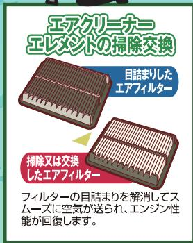
フィルターの目詰まりを解消してスムーズに空気が送られ、エンジン性能が回復します。
