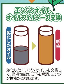
劣化したエンジンオイルを交換して、潤滑性能の低下を解消。エンジン性能が回復します。
