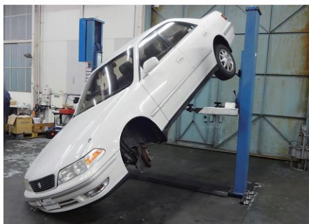
荷重バランスが悪い状況でのリフトアップによる車両落下検証実験写真
