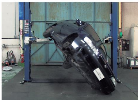
荷重バランスが悪い状況でのリフトアップによる車両落下検証実験写真
