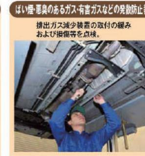
ばい煙・悪臭のあるガス・有害ガスなどの発散防止装置
