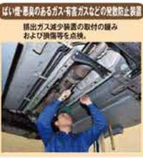
ばい煙器具のあるガス・有害ガスなどの発生防止装置
