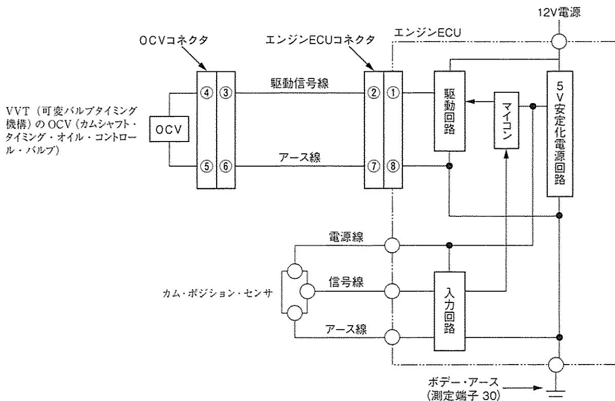
測定端子 30 はエンジンECUコネクタを取り外しても結線されている。
