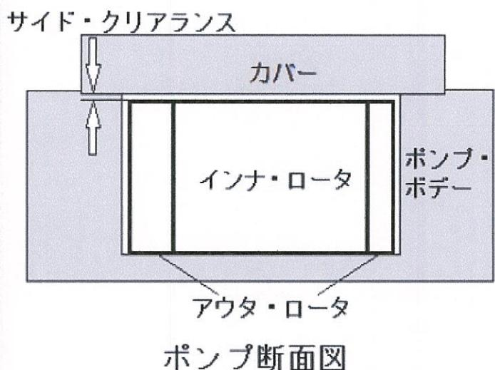
※サイド・クリアランスを測定するときは、ポンプ・ボディに段差があるため、黄色部分にストレート・エッジが掛からない所で行うこと。また、サイド・クリアランスの測定は、インナ・ロータの上端面で行うこと。
